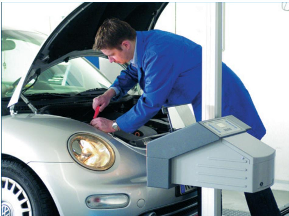
С помощью прибора LITE 3 можно проверять и отрегулировать фары любого типа.
