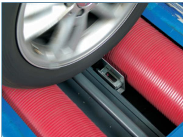
**Лазерный датчик, установленный на роликовом узле тормозного стендса, автоматически измеряет глубину протектора.**
